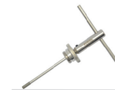
324.44.002 Ferramenta de Retífica do Alojamento do Bastão dos Injetores Denso Ø 4,305mm 324.44.0021 - Haste Ø4,305mm
